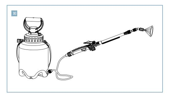
Промойте бак чистой водой. Затем промойте брандспойт, залив в бак чистую воду, накачав давление и распылив воду. Слейте остатки воды, стравите давление и нажав на клавишу ручки брандспойта, распылите остатки воды из брандспойта.
